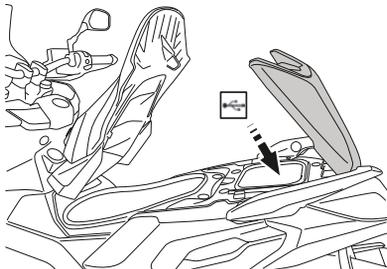
La presa accessori nel vano sottosella, alimentata quando si inserisce il contatto, consente di collegare un dispositivo portatile (Telefono, GPS, ... ) (1 A max.).
