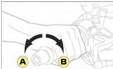
Per aumentare la velocità girare la manopola gas nel senso (A). Per ridurre la velocità girare la manopola gas nel senso (B).
