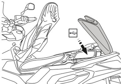
Implantée dans le coffre arrière, une prise accessoires, alimentée à la mise du contact vous permet de brancher un équipement nomade (Téléphone, GPS, ...) (1 A maximum).
