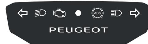
Indicador de fallo del sistema anticontaminación / Autodiagnóstico del motor
