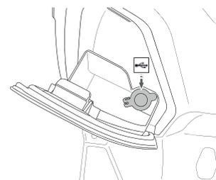
Implantée dans le vide poche, une prise USB, alimentée à la mise du contact vous permet de brancher un équipement nomade (Lecteur MP3, téléphone, GPS, ...).
