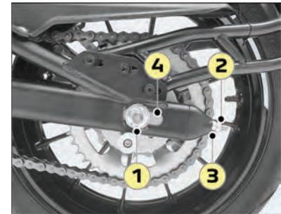
1. Achse/Bolzen Hinterrad.
