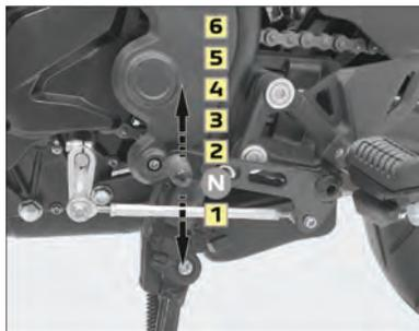
Réduire toujours d'une vitesse à la fois et à la vitesse correcte du véhicule pour éviter que le moteur soit en sur-régime et que la roue arrière ne se bloque.
