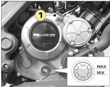
1. Bouchon de remplissage d'huile moteur.
