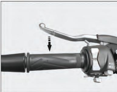
Le levier d'embrayage est équipé d'un contacteur d'embrayage qui est un composant du circuit du coupe-circuit d'allumage. (Voir chapitre : [Coupe-circuit d'allumage](#) page 16 ).
