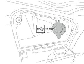
Una toma USB, que se alimenta al poner el contacto y ubicada en la guantera, le permite conectar un dispositivo nómada (Reproductor MP3, teléfono, GPS, ...).
