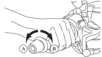
Para aumentar la velocidad, girar el mando del acelerador en el sentido (A). Para reducir la velocidad, girar el mando del acelerador en el sentido (B).
