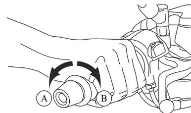
Per aumentare la velocità girare la manopola gas nel senso (A). Per ridurre la velocità girare la manopola gas nel senso (B).
