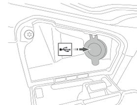
Nel vano portaoggetti si trova una presa USB che viene alimentata quando si inserisce il contatto e permette di collegare un dispositivo mobile (lettore MP3, telefono cellulare, GPS, ecc.).
