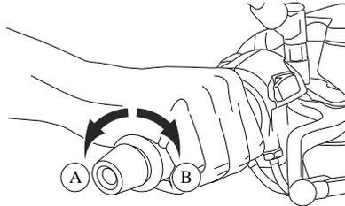
Pour augmenter la vitesse, tourner la poignée de gaz dans le sens (A). Pour réduire la vitesse tourner la poignée de gaz dans le sens (B).
