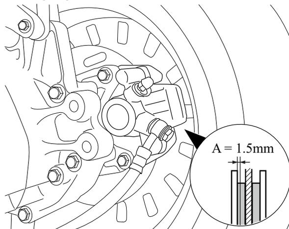
Si l'une des 2 plaquettes est usée jusqu'à la cote minimum (A), il est nécessaire de remplacer les 2 plaquettes de frein.
