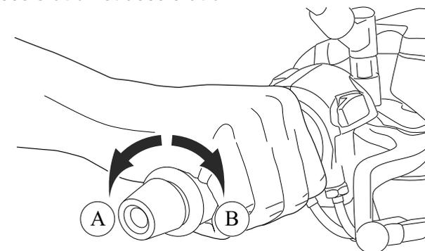
Pour augmenter la vitesse, tourner la poignée de gaz dans le sens (A). Pour réduire la vitesse tourner la poignée de gaz dans le sens (B).
