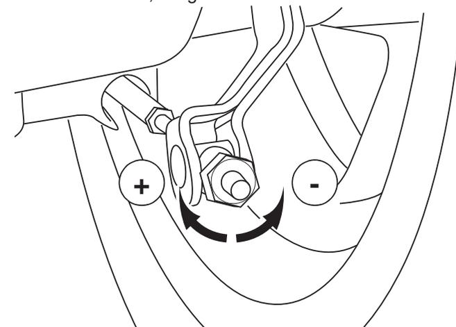
Actionner le levier de frein et vérifier la position du repère d'usure de la biellette de came (B) par rapport au repère (C) du carter moteur.
