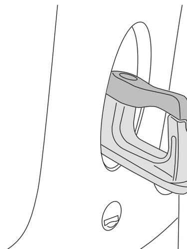
L'accroc sacs est placé au niveau du tablier arrière, celui-ci permet d'accrocher une charge maximum de 2.5 Kg.
