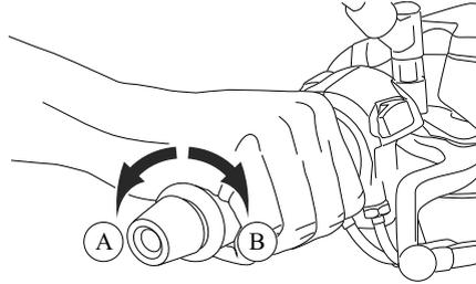
Para aumentar la velocidad, girar el mando del acelerador en el sentido (A). Para reducir la velocidad, girar el mando del acelerador en el sentido (B).
