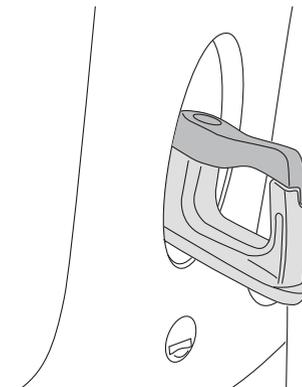
Il portaborse si trova a livello dello scudo posteriore e permette di agganciare e trasportare un carico dal peso di massimo 2.5 kg.
