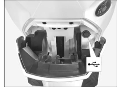
Mientras se usa, el dispositivo se carga automáticamente.
