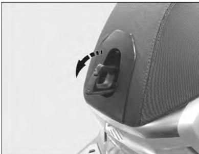
Situado en la parte delantera del sillín, permite colgar una bolsa de una carga máx. de 2.5 kg.
