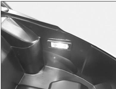
Si un maletero permanece abierto, la luz se apaga automáticamente tras 4 minutos.
