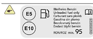
**Se puede utilizar cualquier carburante que contenga hasta un 10% del volumen de etanol (E5, E10).**
